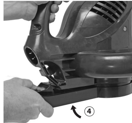
Figura 3-4: Giro de la tapa inferior de la entrada hacia la carcasa de la sopladora/aspiradora
